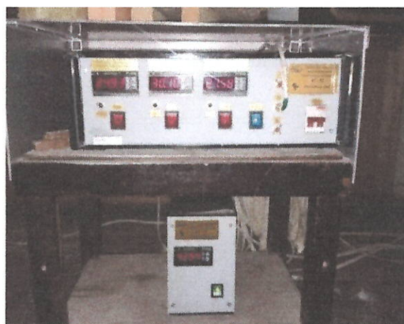
Рисунок 2 – Установка для визначення теплопровідності згідно з ДСТУ Б В.2.7-105-2000 (ГОСТ 7076-99)
